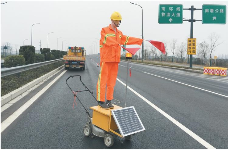
我市青洋路、金武线等快速路建成通车后,由于车流量大,车速快,给公路养护作业带来一定难度。近期,武进公路处首次使用太阳能充电仿真指挥员助力公路养护,这些新型“指挥员”身着橘红色反光工作服,头戴安全帽,不停挥舞手中小红旗,站在作业路段起止线十分醒目。仿真指挥员的加入,不仅降低了养护人工成本,同时也提高了养护作业的安全性。
